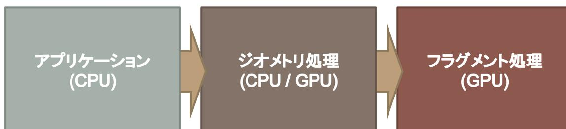
図 11 グラフィックス処理の概念上のパイプライン
