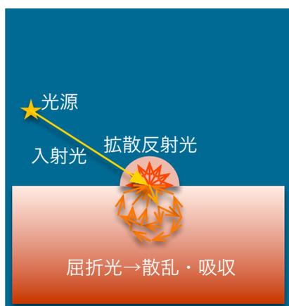
図 137 拡散反射光
