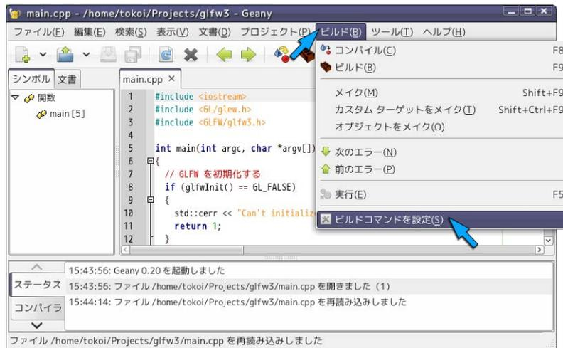
図 38 ビルドコマンドの設定ウィンドウの呼び出し
